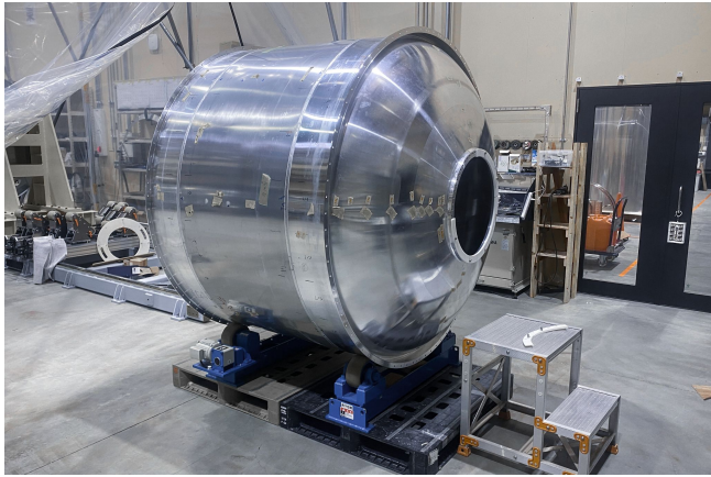
溶接が完了したロケット2段目用推進剤タンク
