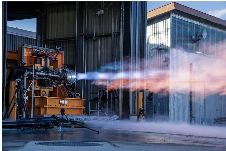
宇宙輸送と宇宙利用を通じて地球の課題解決を目指す宇宙の総合インフラ会社インターステラテクノロジズ株式会社（本社：北海道広尾郡大樹町、代表取締役社長：稲川貴大、以下インターステラテクノロジズ）は、北海道大樹町の宇宙港「北海道スペースポート（HOSPO）」内「Launch Complex-0（LC-0）」にて、小型人工衛星打上げロケット「ZERO」（以下ZERO）のエンジン「COSMOS（コスモス）」の燃焼器単体試験（以下本試験）に成功しましたので、お知らせいたします。本試験では、家畜ふん尿から製造した液化バイオメタン（Liquid Biomethane、以下LBM）を燃料として使用し、十分な性能を有していることも確認しました。バイオメタンによる燃焼試験実施を発表しているのは、欧州宇宙機関（ESA）が開発しているロケットエンジンに続き世界2例目、民間ロケット会社としては初めてとなります（\*1）。
